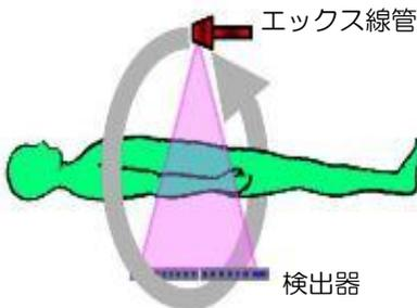
エックス線を回転しながら照射し、対向する検出器で読み取ります。その信号をコンピュータで再計算して画像にしています。
